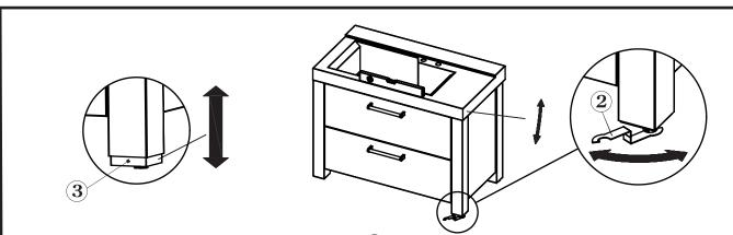
Nel caso che non risulti in "BOLLA" agire con la chiave ②in dotazione, ruotando in <u>senso orario</u> per alzare e/o in <u>senso antiorario</u> per abbassare l'apparecchiatura.
